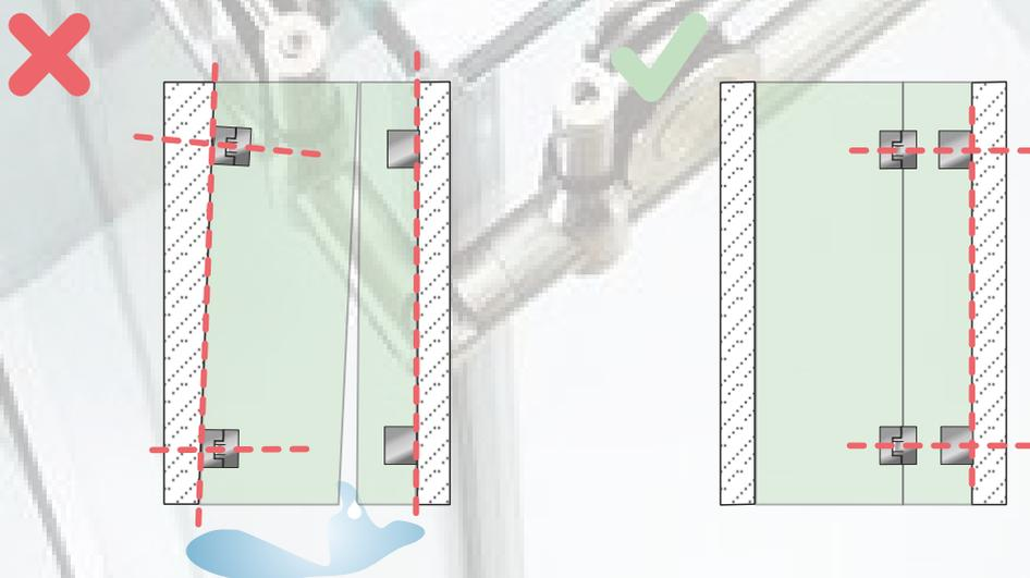
1.10. Конструкция крепежной фурнитуры (петли, коннекторы, профиль) не предусматривает абсолютной герметичности и не рассчитана на прямое воздействие водяной струи, так как имеет движущиеся элементы.
