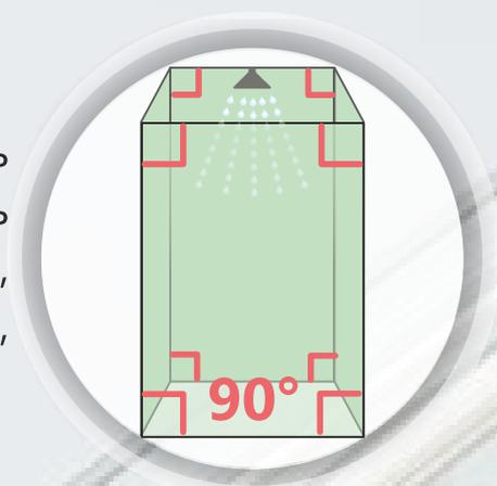
1.6. В местах сопряжения установочной поверхности с элементами душевого ограждения не должно быть бордюров, рельефных узоров, элементов лепнины и т. п., для обеспечения плотного прилегания крепежной фурнитуры и уплотнителей. Все Декоративные выступы и неровности в зоне сопряжения должны быть удалены силами клиента до момента предоставления габаритных размеров изделия, так как их наличие ведет к увеличению зазоров и соответственно водонепроницаемости.
