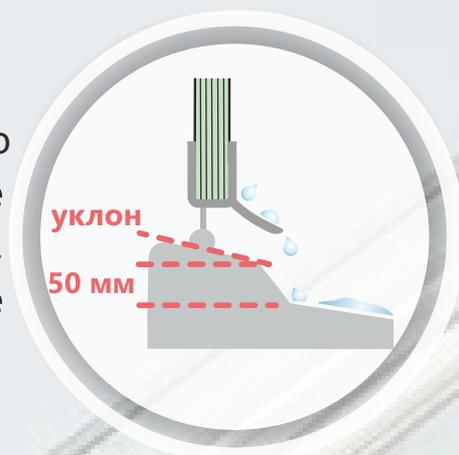
1.12. Основание стен, пол и потолка и отделочные материалы установочных поверхностей должны быть выполнены из только влагостойких материалов. Подготовка поверхности, выбор и качество таких материалов находятся исключительно в зоне ответственности клиента.
