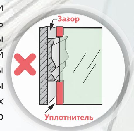
1.7. Особое внимание необходимо уделить затирке межплиточных швов, во избежание возможных протечек швы должны быть устроены строго в одной плоскости с внешней поверхностью плитки.
