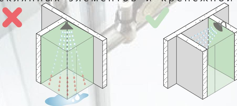
2.9. Для частичной компенсации строительных нарушений, допущенных при подготовке установочных поверхностей, возможна дополнительная герметизация стыков элементов душевого ограждения рекомендованными спецгерметиками.\*
