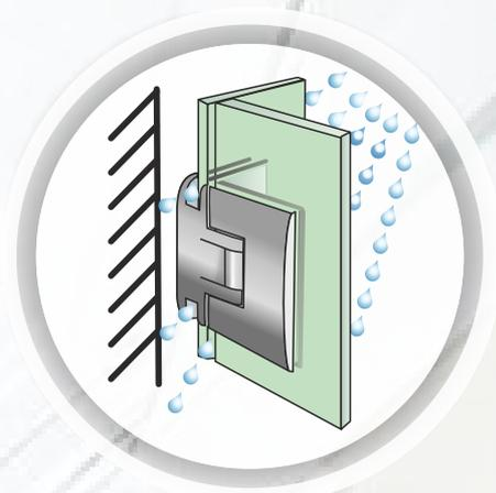
1.11. Во избежание вытекания воды за пределы душевого ограждения необходимо обязательное наличие водоудерживающего бортика высотой не менее 50 мм, верхнее основание которого должно иметь также уклон в сторону слива.
