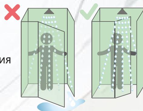
2.6. Использование фурнитуры премиум-класса с повышенным уровнем брызгозащитности и с подъемным механизмом петель
